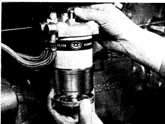
Sl. 4A.5 — Zamena uloška prvog prečistača goriva
