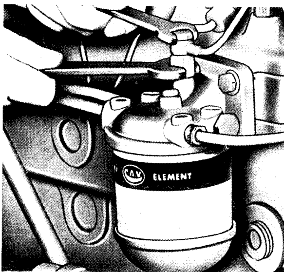
Sl. 2B.54 — Popuštanje šupljeg zavrtnja završnog prečistača goriva
