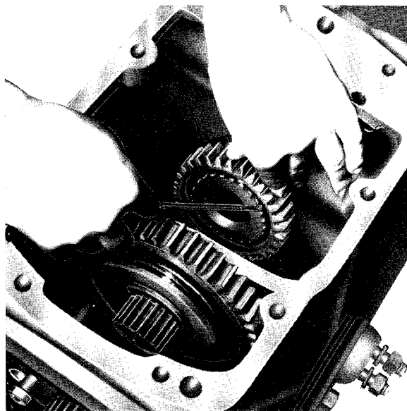
Sl. 8C.3 — Skidanje lamelastog osigurača
